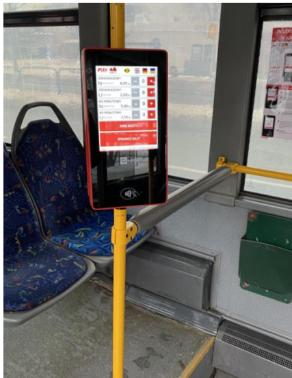
Rys. 10.4 Kasownik mobilny w Komunikacji Miejskiej w Bielsku-Białej (2023 r.)
