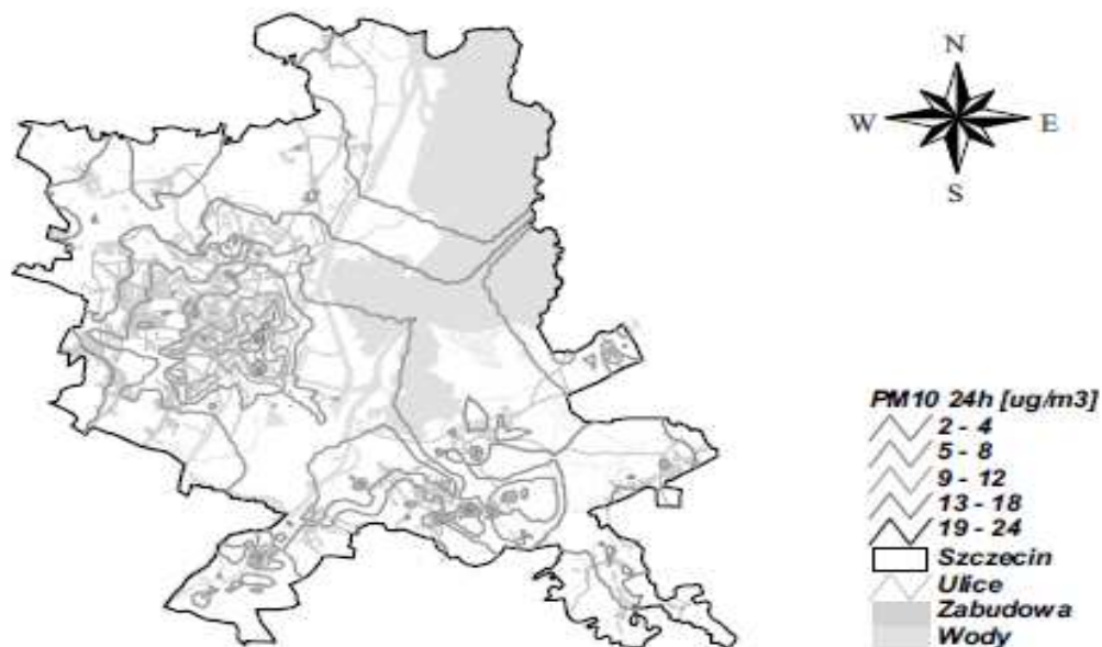
Rysunek 56 Rozkład stężeń PM_{10} 24h (36 max) pochodzących od emisji komunikacyjnej na terenie aglomeracji Szczecin w 2005r.
