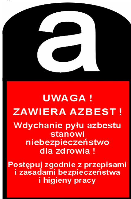
Rys. 16. Wzór oznakowania – pomieszczenie zawiera azbest
