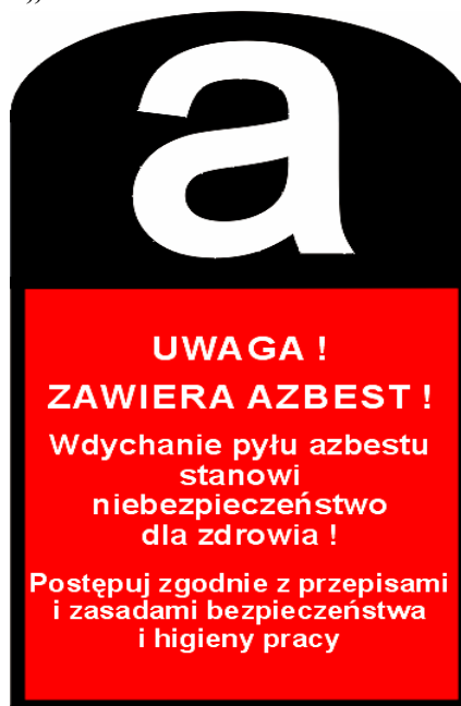
Rys. 16. Wzór oznakowania – pomieszczenie zawiera azbest
