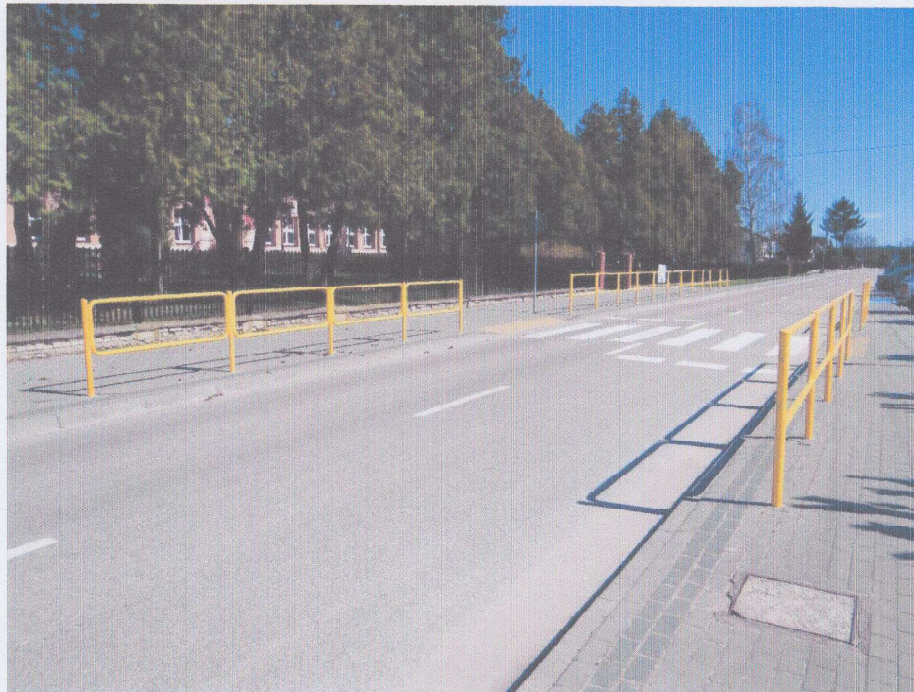
Fotografia 1 . Przejście dla pieszych w ciągu drogi powiatowej nr 1726B przy Zespole Szkół Technicznych ( część ulicy Długiej w Czartajewie ). Ze względu na długie proste odcinki jezdni przed i za przejściem kierowcy często wymuszają pierwszeństwo w stosunku do pieszych oraz przekraczają dopuszczalną prędkość . Kierunek 1
