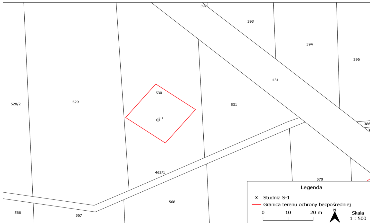
Mapa terenu ochrony bezpośredniej strefy ochronnej ujęcia wody podziemnej dla studni S-1 w miejscowości Łubnice
