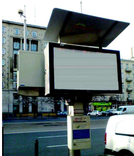
Element automatycznego miernika pyłu zawieszzonego PM10/2,5 na stacji pomiarowej przy ul. Marszałkowskiej w Warszawie.
