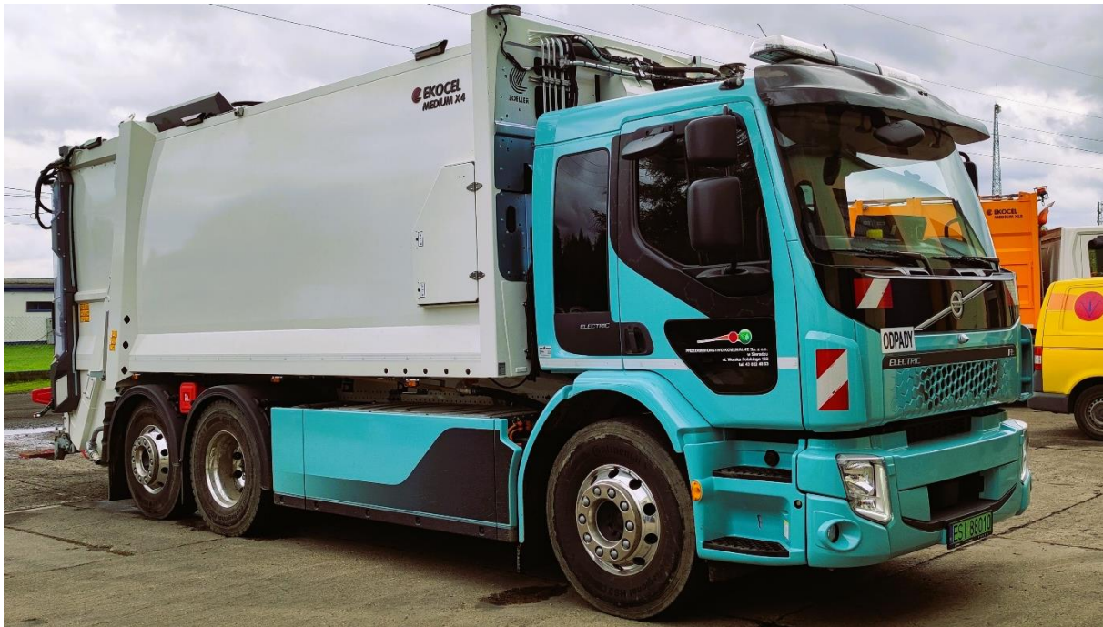
Fot. nr 5. Elektryczny samochód ciężarowy do odbioru niesegregowanych (zmieszanych) odpadów komunalnych - Przedsiębiorstwo Komunalne sp. z o.o. w Sieradzu.
