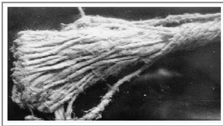
Zdjęcie 7. Sznur azbestowy stosowany w uszczelnieniach izolacji cieplnej.
