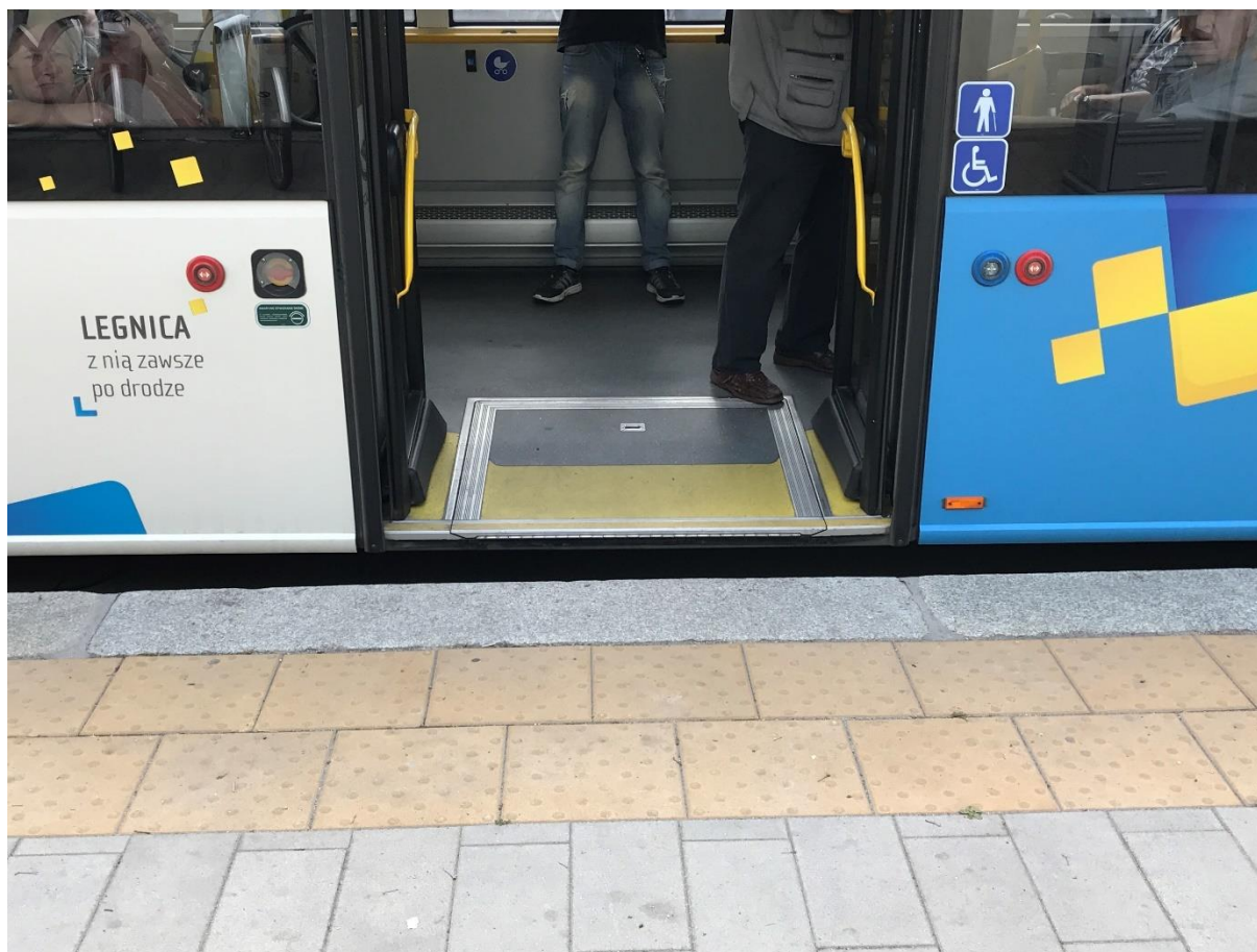
Rys. 7.3 Zminimalizowana przerwa między peronem przystankowym a autobusem
