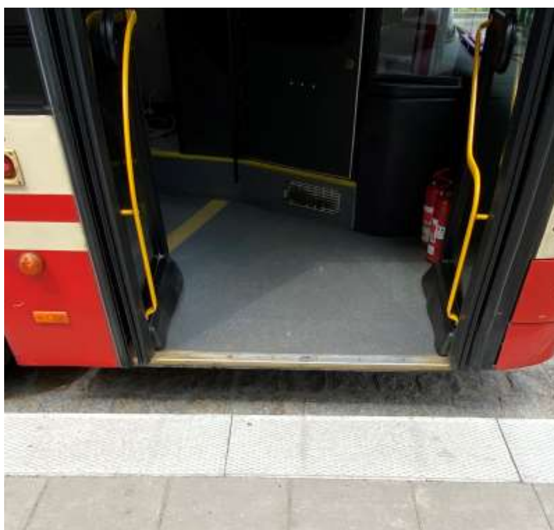
Rys. 9.4 Zminimalizowana przerwa między peronem przystankowym a autobusem
