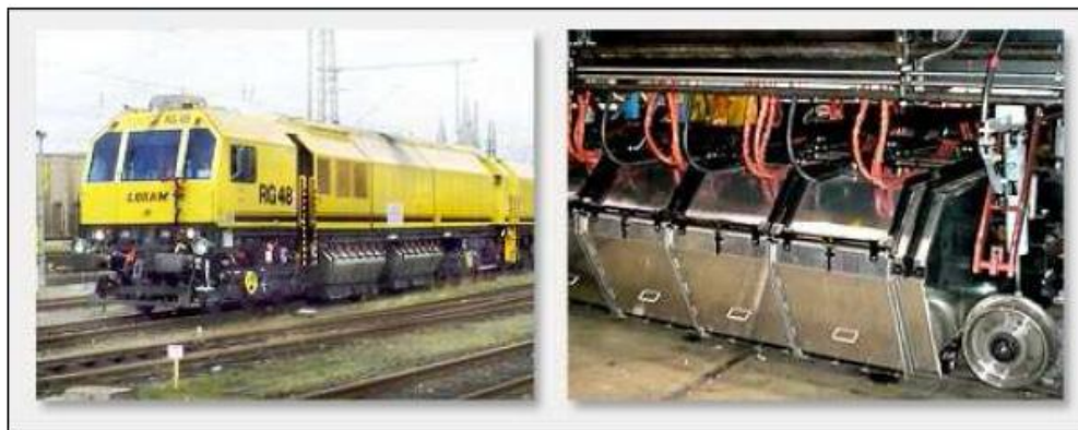
Rysunek 14. Widok maszyny do szlifowania szyn RG 48 I +II ( www.schweerbau.de/ ).
