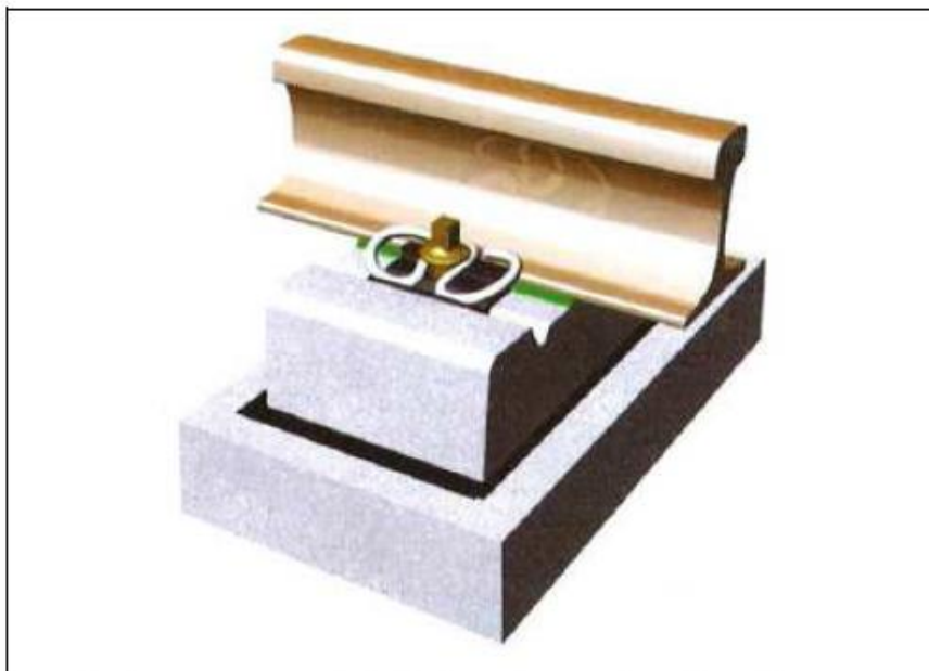
Rysunek 11. Przykładowy system podpór blokowych w otulinie ( http://www.tines.pl ).
