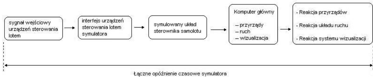
Rysunek 3. Opóźnienie czasowe dla symulacji statku powietrznego sterowanego komputerowo wykorzystującej emulację programową urządzeń statku powietrznego
