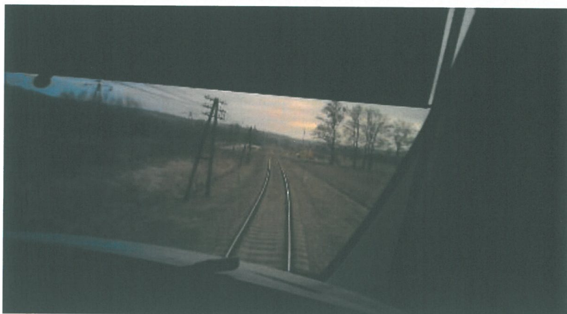
Fot. 2. – słupy utrudniające obserwację
